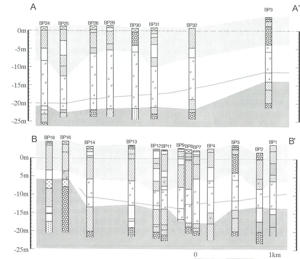
図2 飯梨川デルタの地下断面(位置は図1を参照、地質の記号については付図参照)
